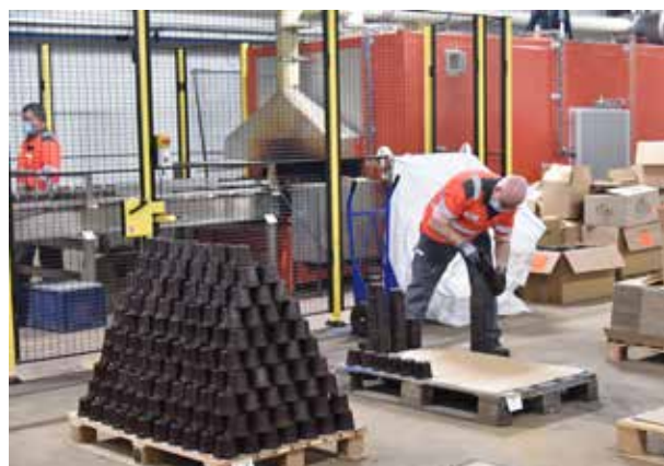
Pot de plantation bio-sourcés (mélange de compost et de déchets de bois) - Entreprise So Ethic à Bonneuil-Matours (86) ©CRNA/F. Roch
